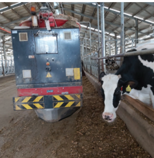
A takarmányrobot napi 6-szori etetésre is képes, 8-10 feltolás mellett, jól szolgálva a tehén igényét a friss takarmányra (Fotó: Orosz, 2021 Emődi Mg. Zrt.)
